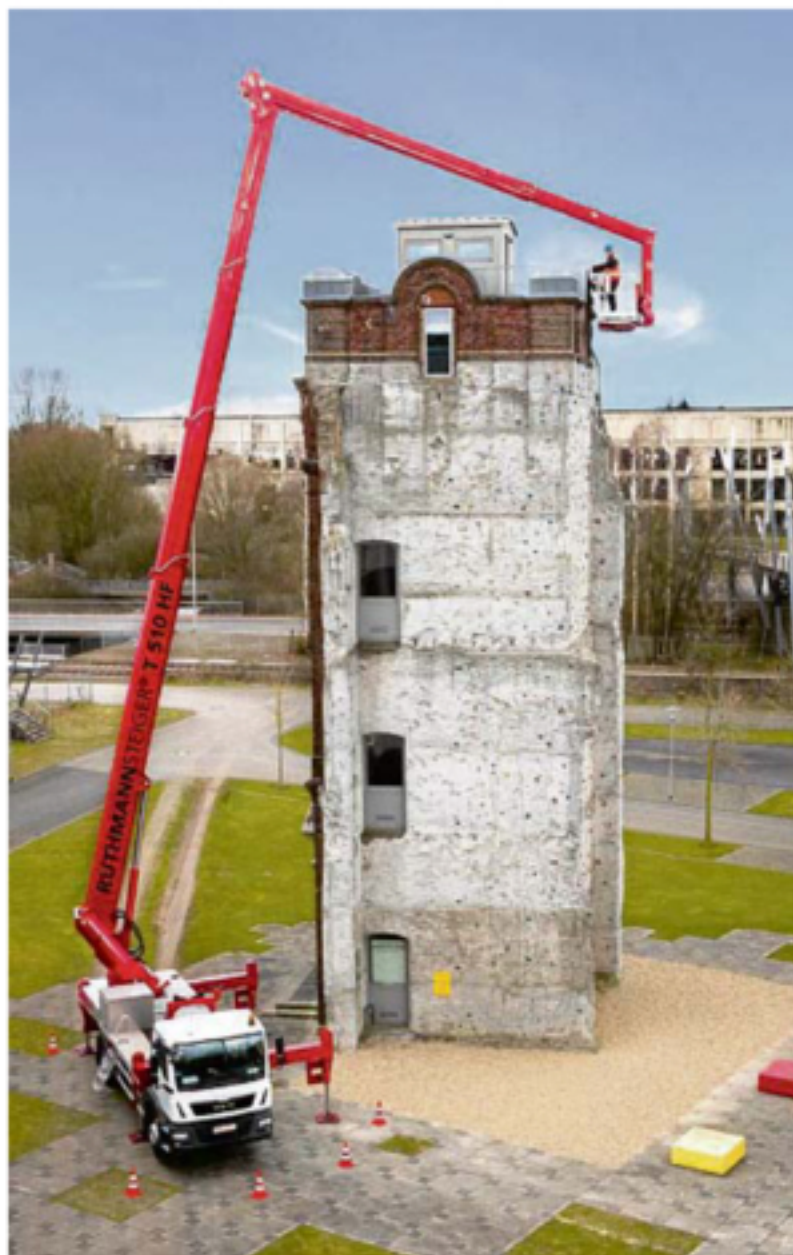
Ruthmanns neueste Lkw-Arbeitsbühnen-Innovation: der Highflex-Steiger T 510 HF mit revolutionären Leistungsdaten: 51 Meter Arbeitshöhe und 33 Meter Reichweite, gepaart mit einem Zwei-Achs-Chassis.
